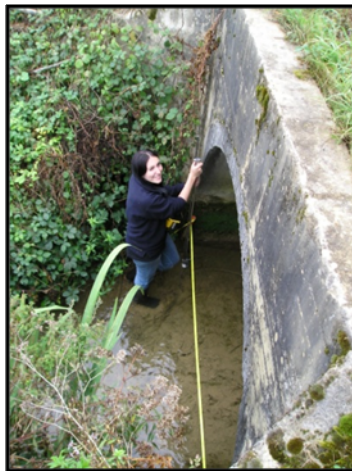
Figure 56 : Mesures du débit sur la Chironde (source : groupe qualité physico-chimique Master GETE, 2007)
